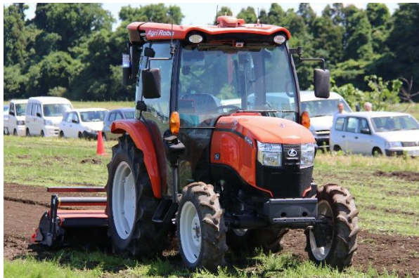
遠隔からの簡易な指示で作業が行える無人自動運転トラクター
